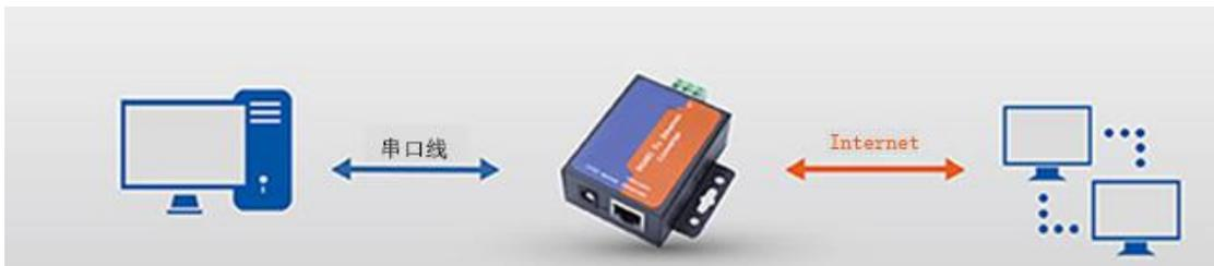
串行通信是指使用一条数据线，将数据一位一位地依次传输，每一位数据占据一个固定的时间长度。由于其通信方式极为原始，发送及响应都需要编写专门程序及协议进行配合。从根源上杜绝了黑客及病毒的传播途径，因此被广泛应用于工业控制领域。
