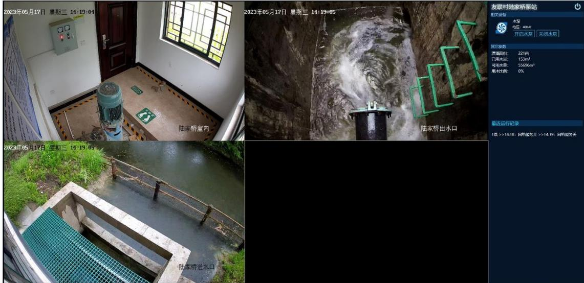
左侧为实时监控画面，根据配套摄像机数量不同，自动设置分屏。支持 1 分屏、4 分屏、9 分屏、16 分屏的显示。
