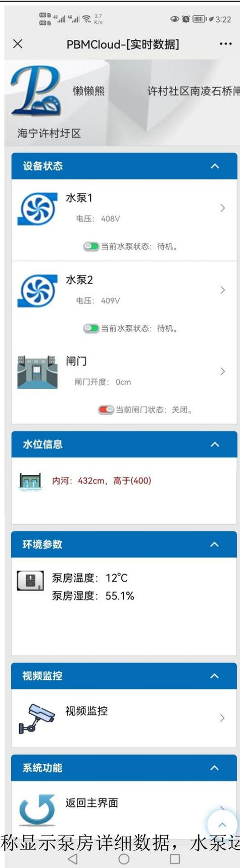
点击水泵名称显示泵房详细数据，水泵运行状态、电压、电流、功率、水位、泵房温度、泵房湿度。及水泵控制、闸门控制、门禁控制、实时视频监控等功能。
