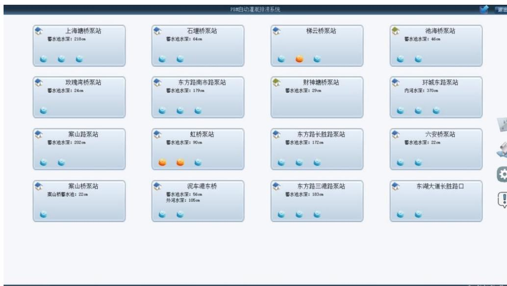
以图标的型式显示所有泵房的状态及主要设备参数。使得操作人员能够直观的了解所有泵房设备的工作情况。
