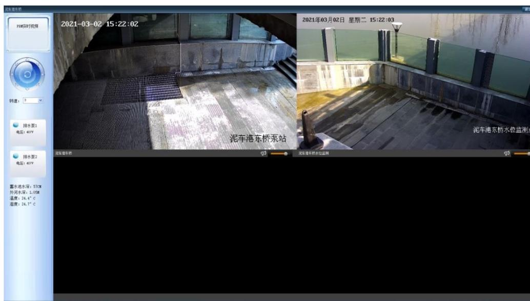
将所有与此泵房有关的控制功能、相关参数、实时视频整合到了一个界面，并以控制图标的方示显示水泵工作状态及参数。以方便用户操作。
