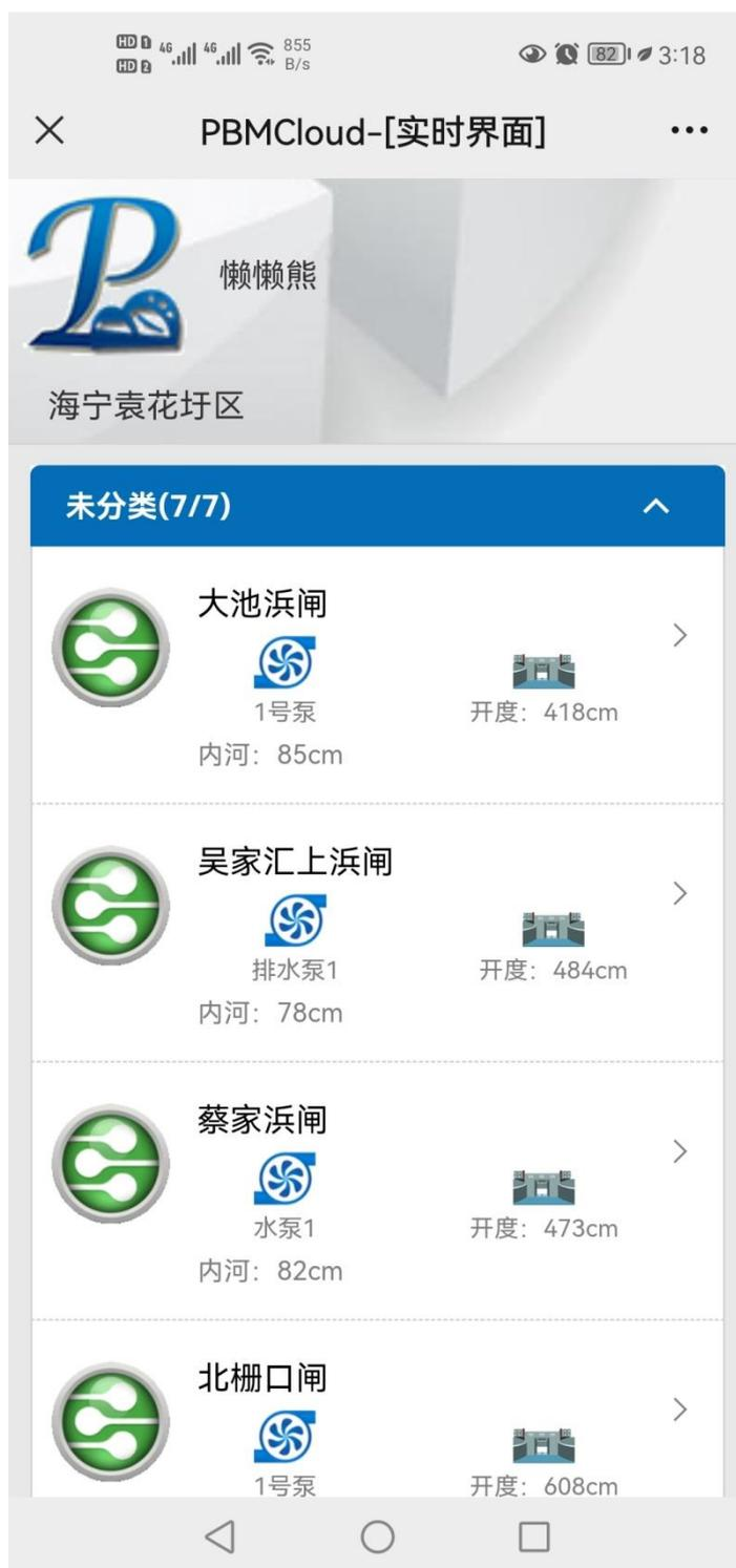
实时查看所有泵站运行数据，并以动画的方式显示水泵工作状态，闸门开启情况，实时显示监测点水位数据。
