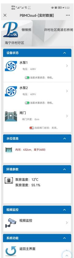
点击水泵名称显示泵房详细数据,水泵运行状态、电压、电流、口率、水位、泵房温度、泵房湿度。及水泵控制、闸门控制、门禁控
