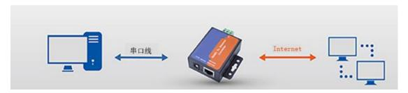
串行通信是指使用一条数据线,将数据一位一位地依次传输,每一位数据占据一个固定的时间长度。由于其通信方式极为原始,发送及响应都需要编写专门程序及协议进行配合。从根源上杜绝了黑客及病毒的传播途径,因此被广泛应用于工业控制领域。
